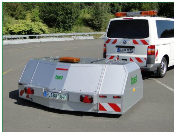
Abb.3 Lärmmessung des Fahrbahnbelags
