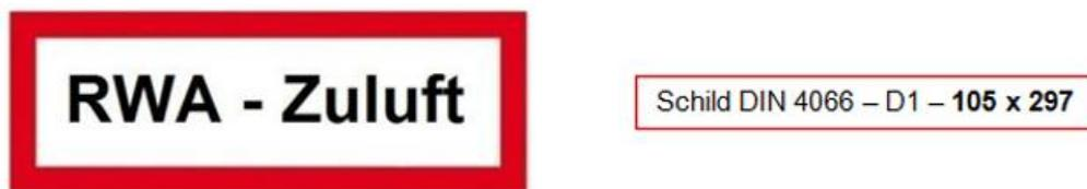
Abbildung 1 Kennzeichnung von Zuluffflächen (bspw. Tore)
