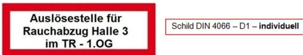
*Abbildung 5 Kennzeichnung von Auslösestellen für NRA in Sonderfällen*
