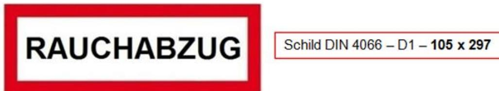
Abbildung 3 Kennzeichnung von Rauchableitungsöffnungen (bspw. Tore)
