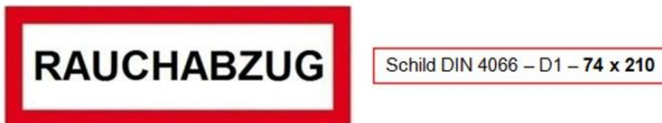
*Abbildung 6 Kennzeichnung von Bedienungsvorrichtung zur Öffnung von Rauchableitungsöffnungen*
