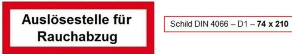
*Abbildung 4 Kennzeichnung von Auslösestellen für NRA*
