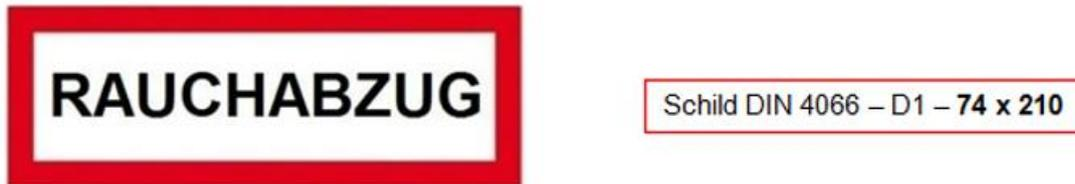
Abbildung 2 Kennzeichnung von Bedienungsvorrichtungen zur Öffnung von Rauchableitungsöffnungen
