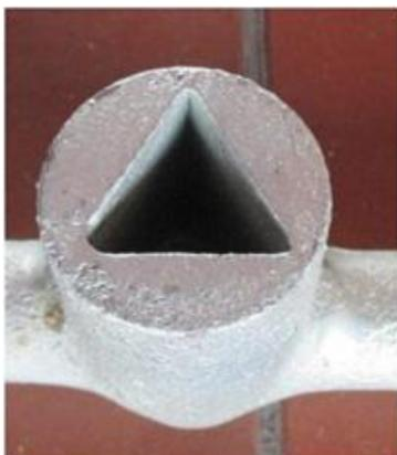
Abbildung 3 Dreikanteinsatz am Überflurhydrantenschlüssel
