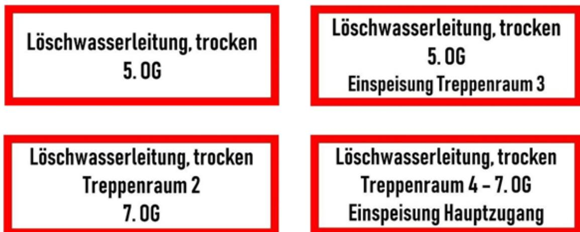
Abbildung 4 Beschilderung Löschwasserleitung
