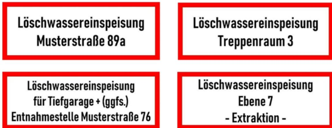
Abbildung 3 Beschilderung Löschwassereinspeisung
