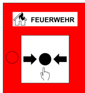
Handfeuermelder mit Aufschaltung zur Feuerwehr
