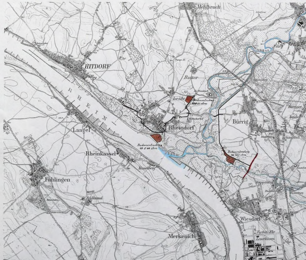
Abb. 48: In dieser Karte der Oberdeichinspektion vom 07.11.1909 sind ebenfalls die Deiche in Rheindorf und Bürrig enthalten (fette schwarze Linien). Zusätzlich werden aber auch die 3 Flächen dargestellt, auf denen der für den Bau der Deiche erforderliche Boden entnommen wurde. Die fette Linie in Bürrig, die die Dhünn kreuzt, zeigt den hochwasserfreien Ausbau des Weges Bürrig - Wiesdorf.
