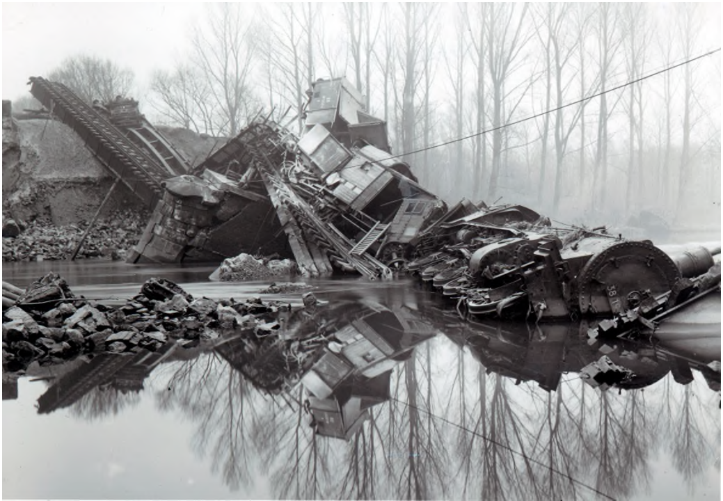
Abb. 30: 38 1910, ein Packwagen und drei Güterwagen sind am 09.02.1946 in die Wupper bei Opladen gestürzt. Mindestens 13 Monate wird die Lokomotive in der Wupper liegen, bevor sie geborgen und wieder aufgearbeitet wird.
